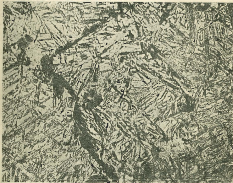
Фиг. 13-в. Структура мартенсита на расстоянии 4 мм от поверхности катания ( \times 500 )
