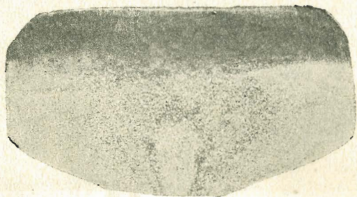
Фиг. 10. Конец рельса № 2. Нагрев коксовым газом 4 мин. 40 сек. Замочка 5 сек.
