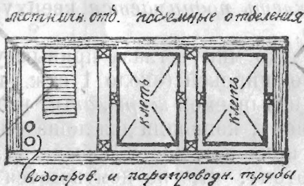
Рис. 9. Поперечное сечение шахты, укрепленной деревом.
