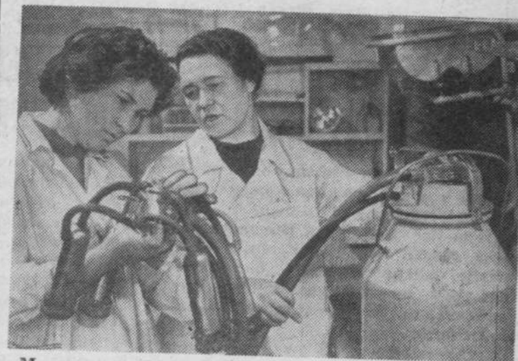
Московская область. В лаборатории машинного доения и первичной обработки молока Всесоюзного научно-исследовательского института электрификации сельского хозяйства разработали новый аппарат, который назвали «Автомат». Он выдаивает коров быстрее и, главное, полнее, чем аппараты других систем.
