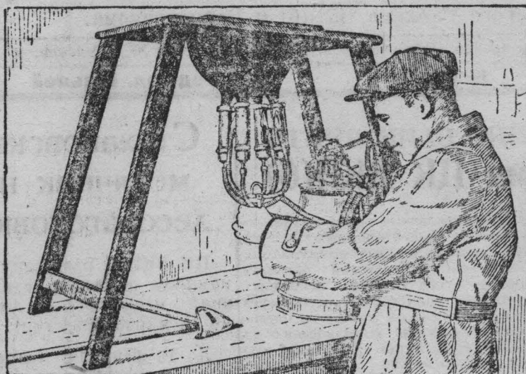
Инженер В. Ф. Королев производит лабораторные испытания новой электродоильной установки.
