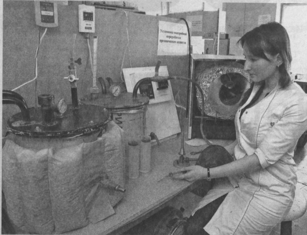
■ Ирина Козлова зажигает биогаз, полученный на газовом реакторе. Фото Федора Баранова.
