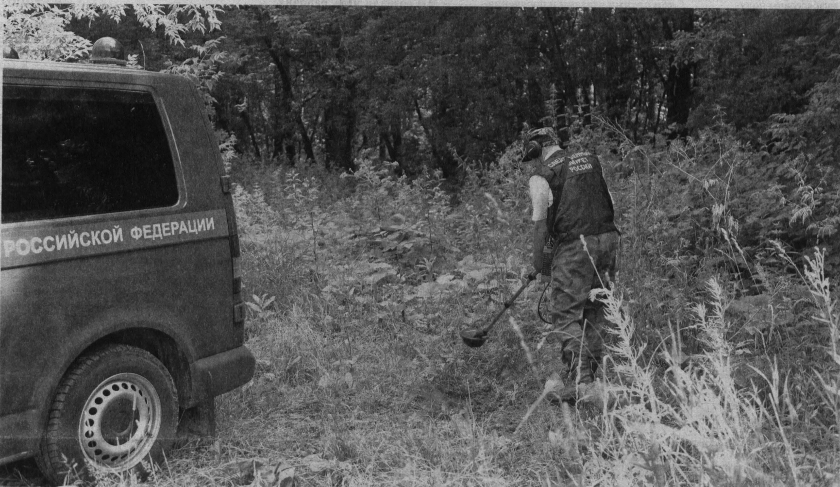
С помощью нелинейного локатора сотрудники регионального Следственного комитета могут найти различные электронные устройства на полупроводниках – мобильники, навигаторы, пейджеры, кардиостимуляторы и т. д. Даже если те выключены или не работают. Фото Александра Зубарева.
