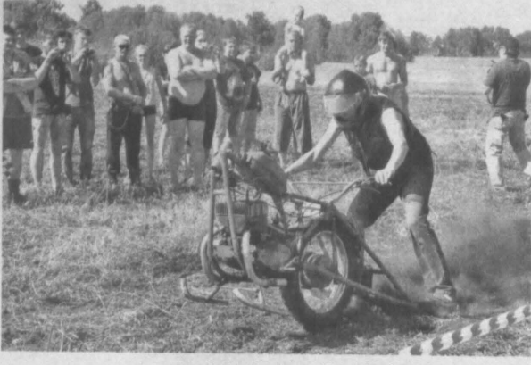
Унимото, или уницикл, построен на базе мотоблока с одним колесом и полوزьями. Он предназначен для быстрой езды по льду, снегу или грунту. Фото Игоря Смирнова.
