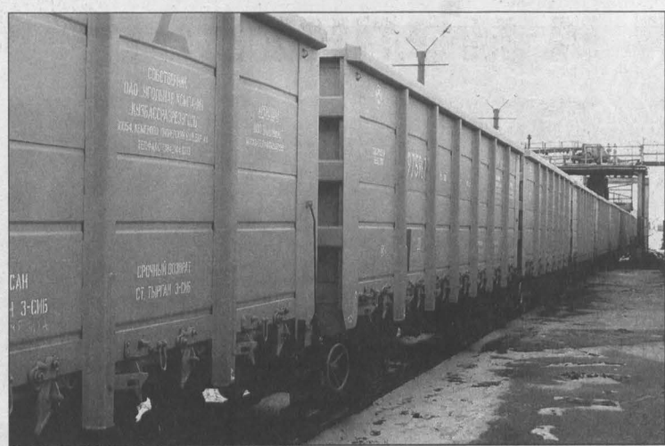
Каждый такой вагон при собственном весе более 20 тонн может транспортировать до 70 тонн угля.
