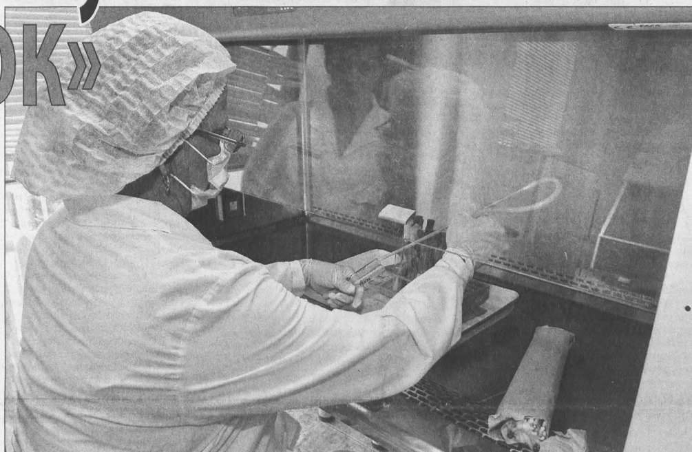
Шкаф безопасности позволяет «вывести» руки лаборанта в особую зону и уже там выполнять манипуляции с разным биоматериалом.
