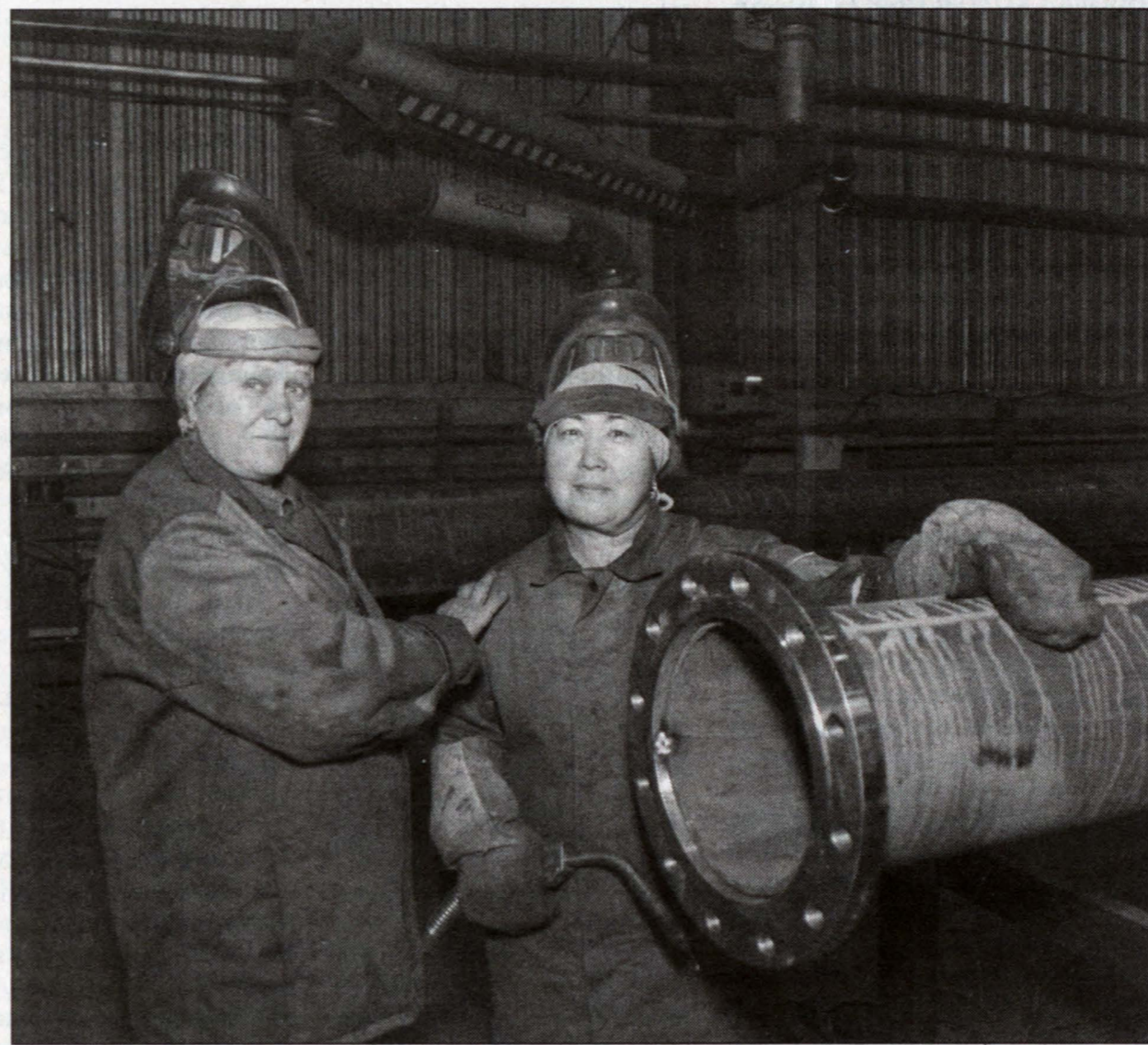
Сварщицы Анна Медведева и Римма Акушакова выполняют офланцовку труб.
