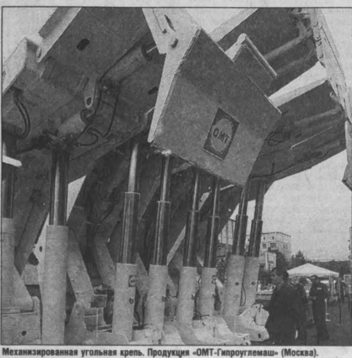
Механизированная угольная крепь. Продукция «ОМТ-Гипроуголемаш» (Москва).
