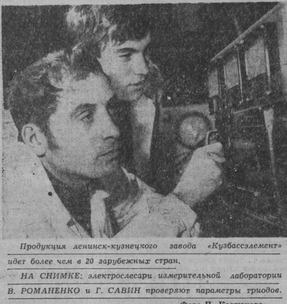
Продукция Ленинск-Кузнецкого завода «Кузбассэлемент» идет более чем в 20 зарубежных стран. НА СНИМКЕ: электрослесари измерительной лаборатории В. РОМАНЕНКО и Г. САВИН проверяют параметры триодов.
