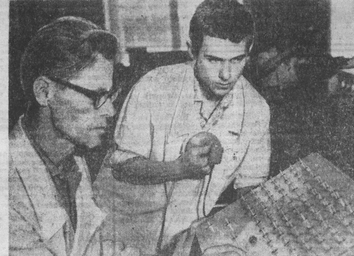
К началу учебного года московский завод «Физэлектронприбор» выпускает первую партию «линфофонных кабинетов» для школ. Так называется комплекс приборов для обучения иностранному языку, в который входят два магнитофона, усилители и аппарат дистанционной связи, рассчитанный на 42 учащихся. НА СНИМКЕ: сборщики В. А. Воробей (слева) и В. Д. Выхров регулируют пульт управления линфофонного кабинета. Фотохроника ТАСС.
