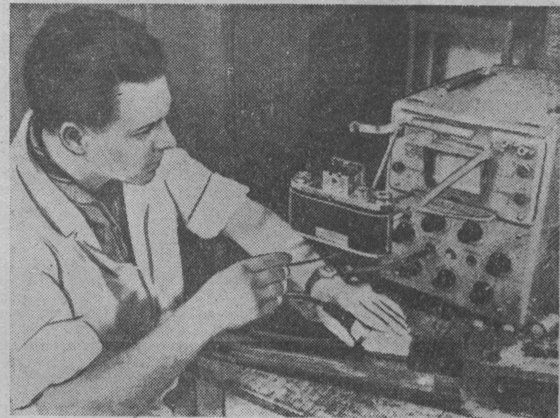
Ультразвук находит все большее применение в различных отраслях промышленности. Инженер В. ЦЕЛМАН проверяет прочность промежуточной опоры на ультразвуковом приборе.
