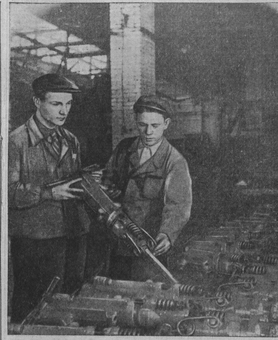
Кузнецкий машиностроительный завод выпускает различное оборудование для угольной промышленности. Хорошо работает на сборке пневматических ломов слесарь-сборщик П. М. Якубенко. Сменное задание он ежедневно выполняет на 300—320 процентов.
