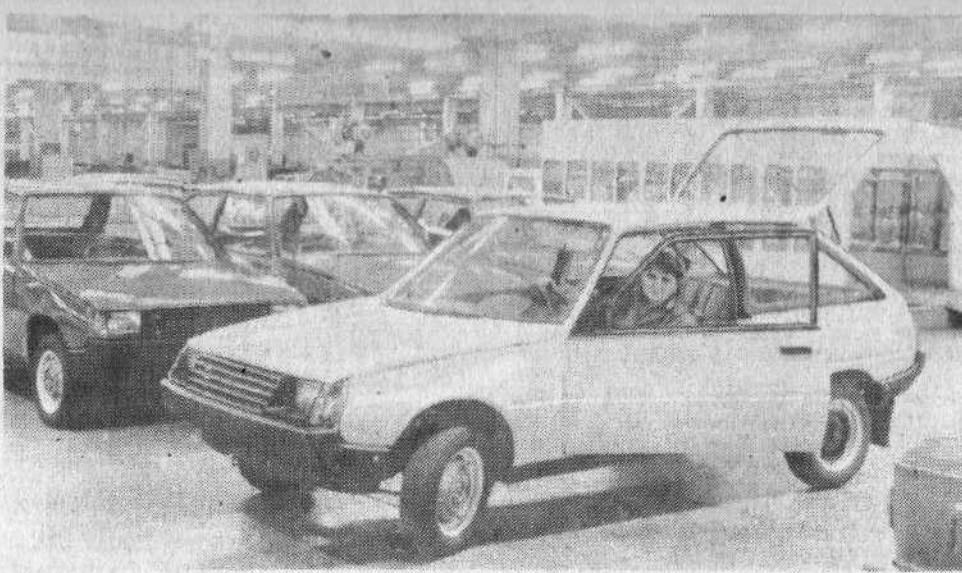
километров в час. Улучшена динамика 50-сильного двигателя, оснащеннего пятиступенчатой коробкой передач. Новый «Запорожец» легче на 110
