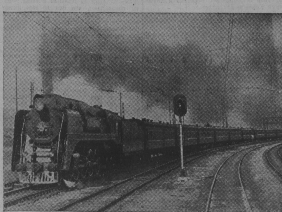
Москва. Коломенским паровозостроительным заводом имени Куйбышева выпущен пассажирский паровоз «П 36-0002» типа «2-4-2».
