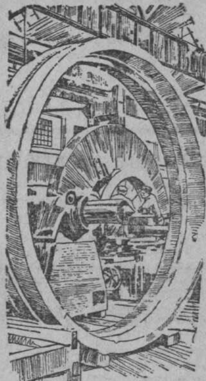
Уральский завод тяжелого машиностроения. На снимке: гигантский лоботоканарный станок. Ударники Антонов и Кудрявцев обтачивают фланец барабана для паровой мельницы. (Союзфото)
