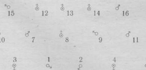
Всего в забое штreta бурится 16 шпуров глубиной 1,5—1,6 метра. Путем много-кратной проверки нескольких вариантов расположения шпуров и очередности их взрываания применительно к геологическим условиям пласта 3-го «Внутреннего» выбран вариант, при котором сила взрыва используется в максимальной мере.
